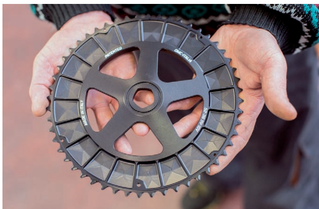
Dvojprevodník OMC vyrobený z jedného kusa materiálu spolu s dutými kľukami, ktorý I. Cavallaro vyrába na stroji UMC-750, má označenie V-Strong One
